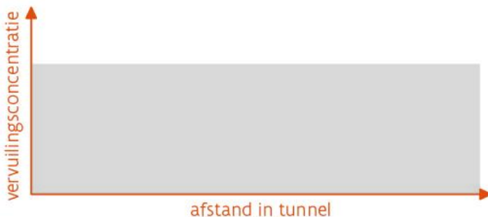
Figuur 1-10: Concentratieverloop van de vervuiling met uitsluitend dwarsventilatie zonder stroming in lengterichting
