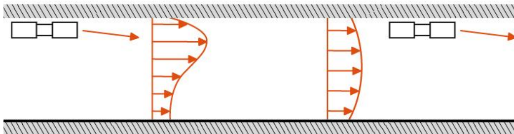
Figuur 2-7: Uitmiddeling uitblaasstraal opeenvolgende ventilatoren
