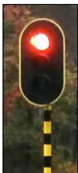
Figuur 21 Licht voor gemotoriseerd verkeer of gemengd verkeer ("Volle lens")
