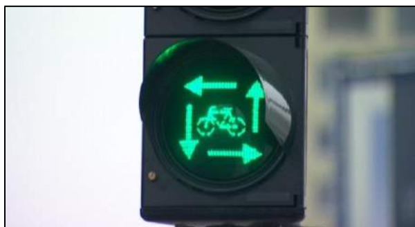
Figuur 54 Voorbeeld van een "vierkant groen"-verkeerslicht
