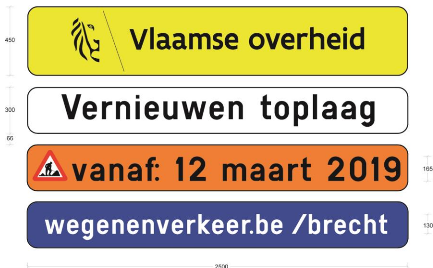
Figuur 10.4.4.: Vooraankondiging voor wegen met een maximumsnelheid tot 90 km/u
