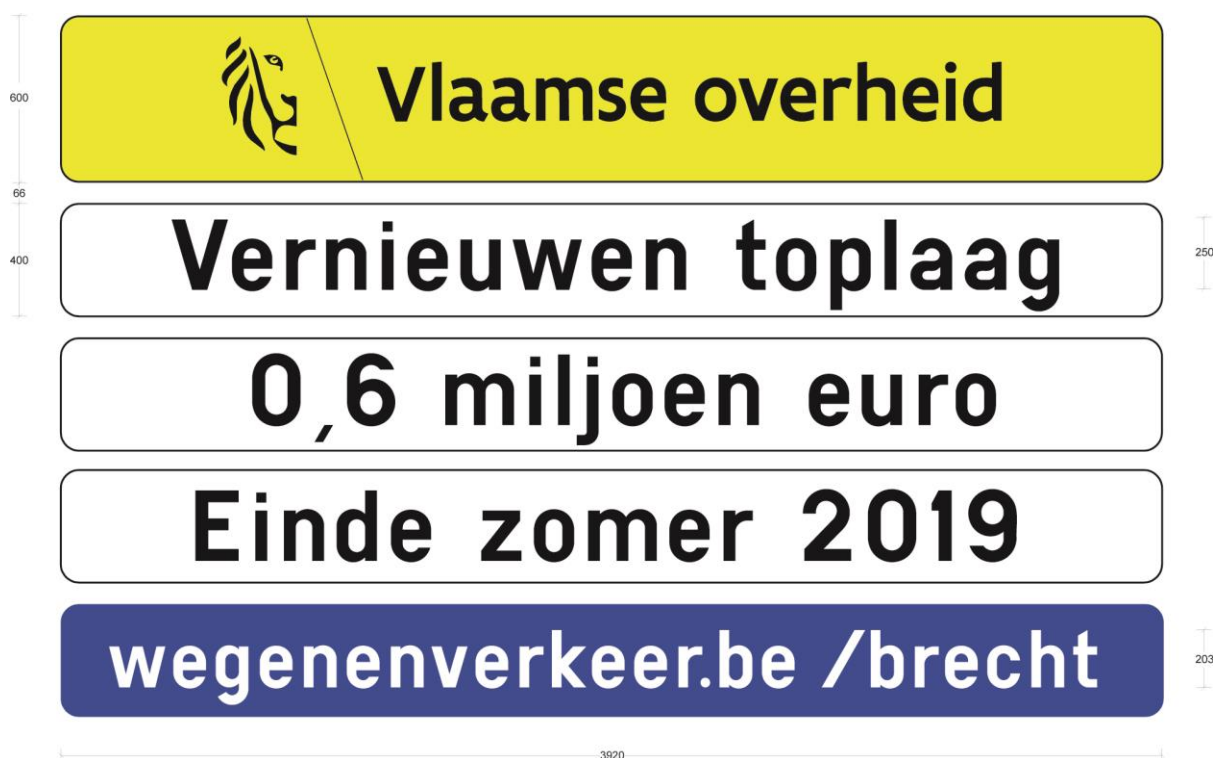
Figuur 10-4-1: werfaankondiging voor wegen met een maximumsnelheid van 90 km/h tot 120 km/h (reguliere snelheid)
