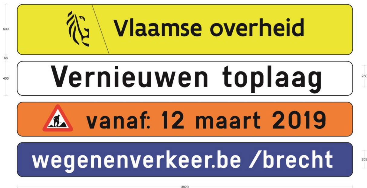
Figuur 10.4.3. Vooraankondiging voor wegen met een maximumsnelheid van 90 km/u tot 120 km/u (reguliere snelheid)
