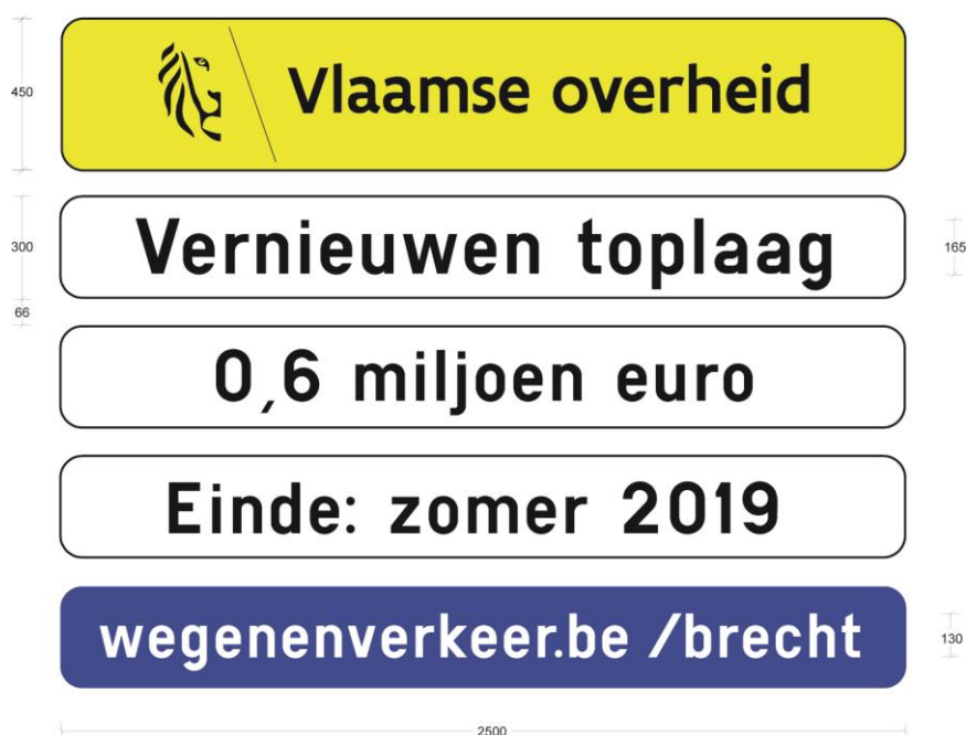
Figuur 10-4-2: werfaankondiging voor wegen met een maximumsnelheid tot 90 km/h (reguliere snelheid)
