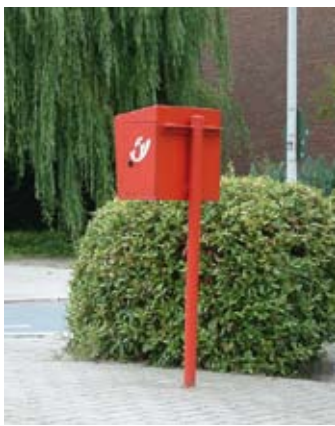
Fig. 2.1.1o Deze brievenbus is van boven veel breder dan op grondniveau tastbaar is. Een dergelijk obstakel hoort op de looproutte zeker niet thuis.
