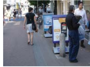
Fig. 2.1.3o Een goot kan goed dienst doen als gidslijn. De goot is geaccentueerd met een contrasterende kleur ten opzichte van de aanliggende verharding.
