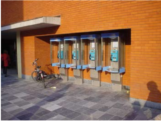
Fig.2.1.1e De telefooncellen werden in een nis buiten de looproute geplaatst. De losse fiets verstoort de gidslijn.
