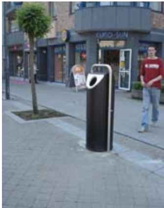
Fig. 2.1.1l Een kolomvormige vuilnisbak is vanaf grondniveau tastbaar.
